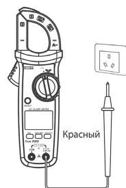
Рис. 6 Определение нуля и фазы
