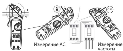
Рис. 2 Измерение силы и частоты переменного тока
